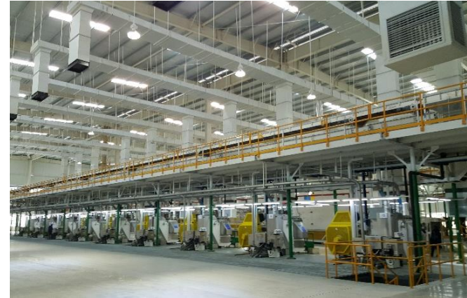
美國Stolle高速產線(鋁罐) 每分鐘最快可達3000罐
