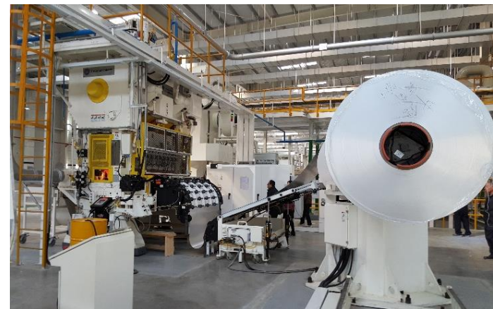
美國Stolle高速產線(鋁罐)
